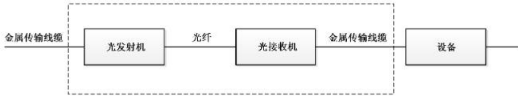
图 A.1 信号隔离器功能框图
