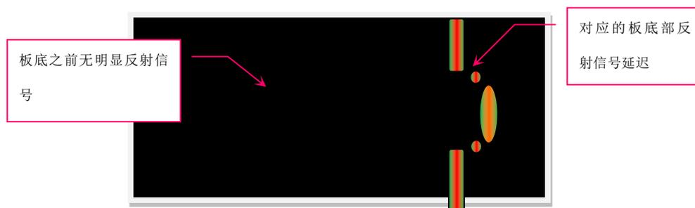
图 B.5 空洞型缺陷（铁皮波纹管）的云图（色板-5）
