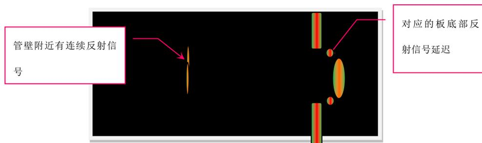
图 B.4 空洞型缺陷（塑料波纹管）的云图（色板-4）
