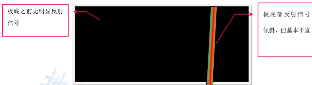
图 B.2 密实部位的云图（色板-2）
