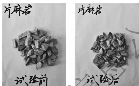
图 T 0363-2 片麻岩测定前后表面状况比较
