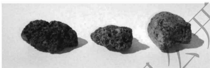
图 T 0346-5 至少两个破碎面(具有略钝边缘、粗糙表面)
