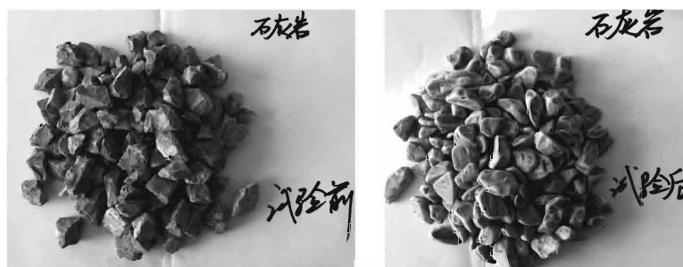
图 T 0363-1 石灰岩测定前后表面状况比较
