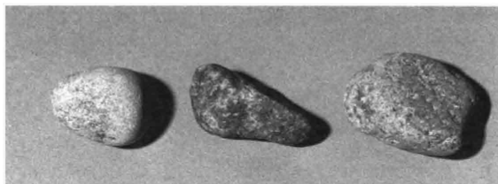
图 T 0346-9 无破碎面(圆颗粒、光滑表面)
