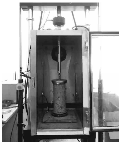
图 T 0863-3 无机结合料稳定材料拉伸试验
