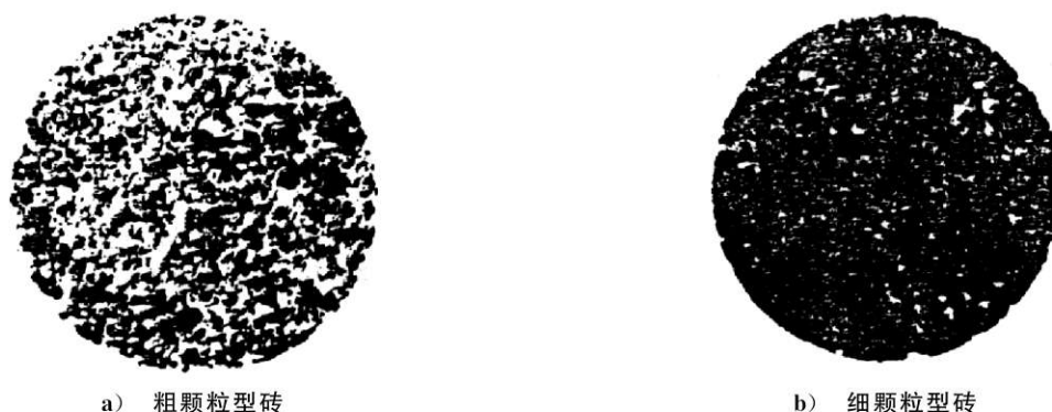
图 2 合格试样的复写纸印痕示意图
