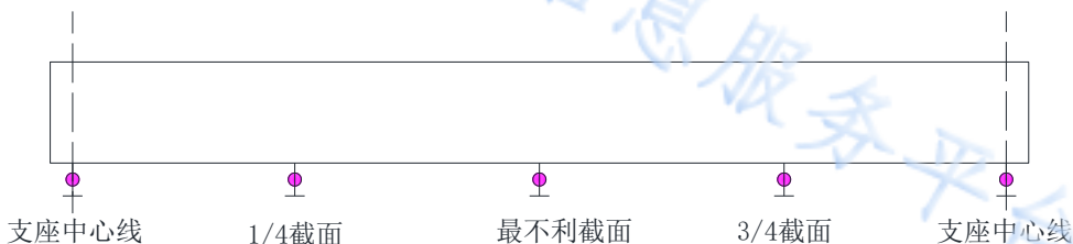
图3 预制混凝土梁竖向位移测点立面布置示意图
