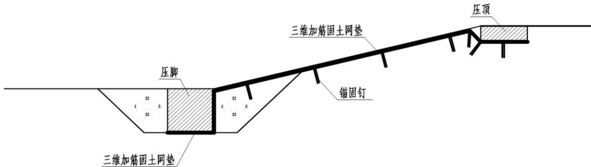
图3 三维加筋固土网垫锚固示意图
