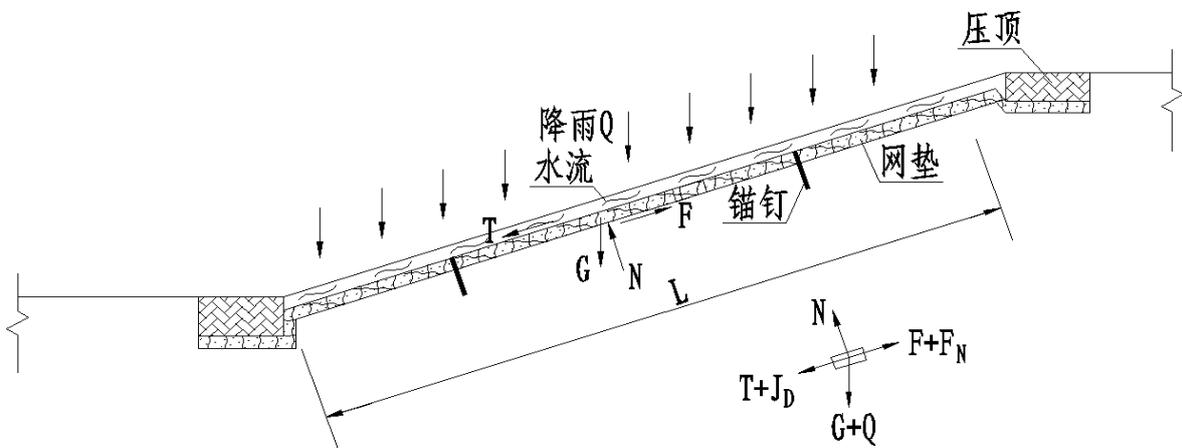
图A.1 三维加筋固土网垫受力分析
